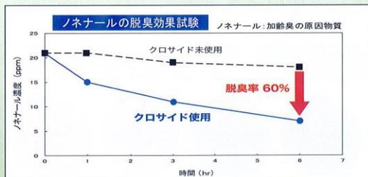
【方法】検体をおい袋に入れ、ヒートシールを施した後、空気を封入し、設定したガス濃度となるように試験対象ガスを9Lとした。これを静置し、経過時間ごとにガスを捕集し、イオンクロマト法にて測定した。
